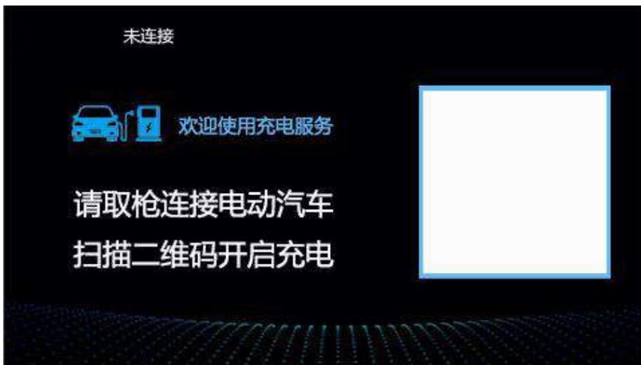
(2) 按提示将充电枪插入充电插座中进入下面的界面，按提示扫二维码进入“共享充”微信公众号，登录并充值后可再次扫码点击开始充电。
